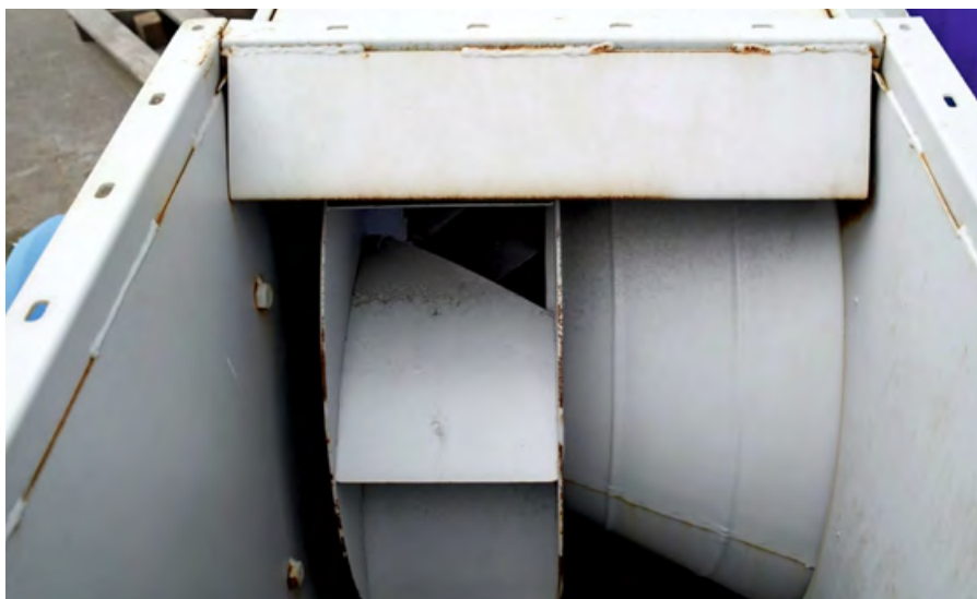
❖ Фото 2. Значительно упрощён аэродинамический вход потока в колесо. Колесо с плоским передним диском. Плохая окраска — корпус ржавеет через месяц хранения на улице
