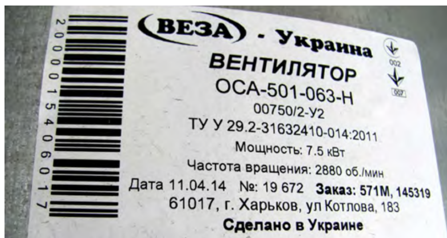
❖ Фото 6. Все заводы «ВЕЗА», включая производство в Гомеле, Брянске, Миассе и Харькове, имеют единую систему учёта маркировок готовой продукции для сканирования по штрих-кодам. Все изделия произведены строго под заказ. №145319 — шестизначный номер счета «ВЕЗА» — можно проверить по базе данных «1С» простым телефонным звонком
