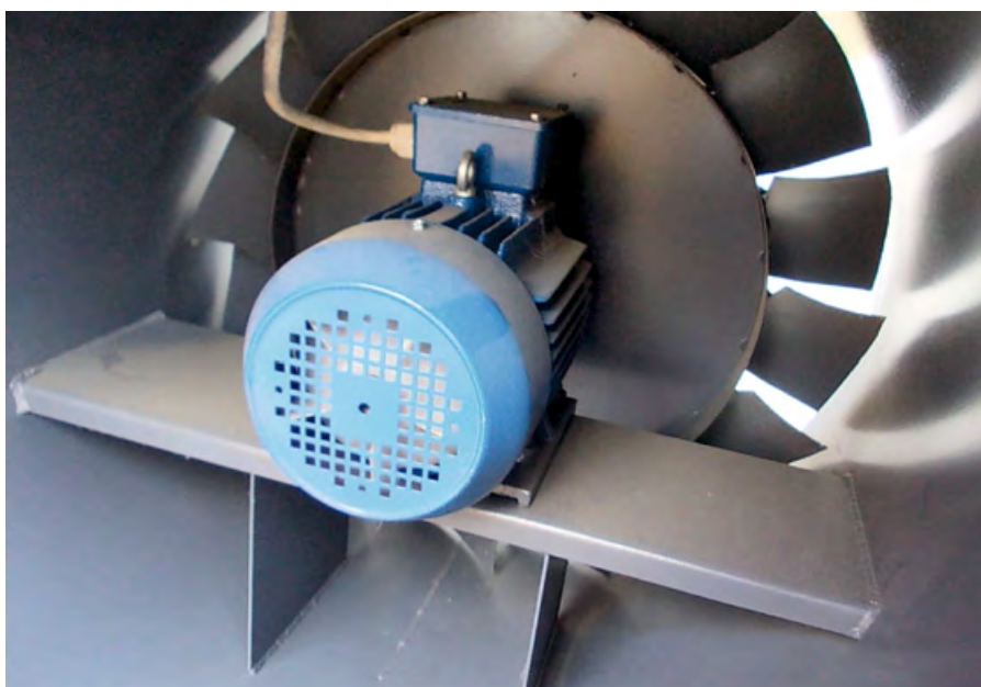
❖ Фото 4. Серийный «нонейм», выдаваемый по документам за технику «ВЕЗА». Непрочный прерывистый шов на корпусе. Китайский электродвигатель. Большие зазоры на колесе. Неаэродинамическая стойка мотора
